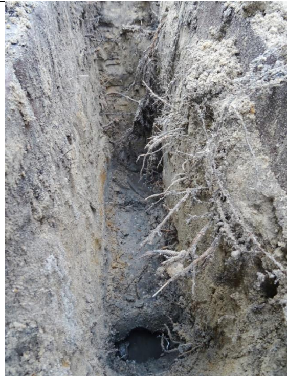
Extensieve tot matig intensieve beworteling in de sleuf. In het boorgat is het grondwater enigszins zichtbaar.
