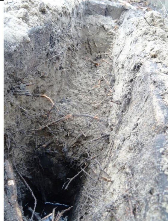
Zeer intensieve beworteling direct onder de klinkers. Deze laag is 37 cm dik. Om wortels te sparen is niet door de hele laag heen gegraven. Op de voorgrond is de grondwaterspiegel zichtbaar.
